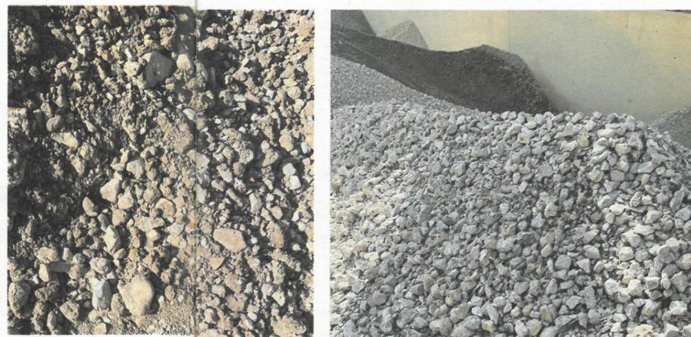
Près de 80% des matériaux d'excavation, destinés à la décharge, sont revalorisés en béton et en enrobés bitumineux grâce à la centrale de valorisation.
