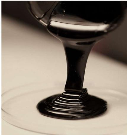
Abb. 1: Bitumen ist der Klebstoff im Asphalt.
